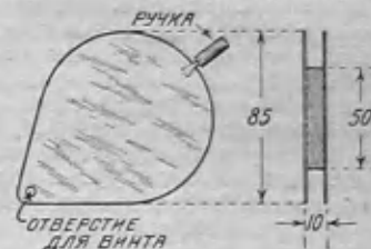
Рис. 2. Размеры катушек L_1 и L_2 ; слева диск для регулирования связи между ними.
